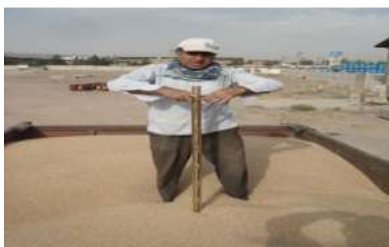
شکل ۱۶. الف، ب) روش نمونه‌برداری عمودی از پارت‌های بذری با استفاده از سوک دو جداره با طول و قطر کافی (به صورت عمودی یا زاویه‌دار). ج) تصویری از یک جامبوبگ
