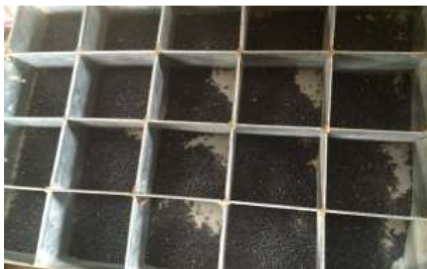
شکل ۱۲. ابزاری برای مقایسه همگنی نمونه‌های اولیه در نمونه برداری با سوک دوجداره یا حتی سوک ناب
