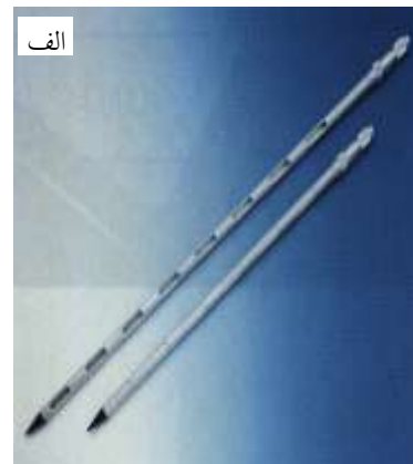
شکل ۱۰. الف) انواع سوک دوجداره؛ ب) حفره‌های لوله درونی و بیرونی که در مقابل یکدیگر قرار گرفته‌اند؛ ج) سینی برای تخلیه سوک‌های دوجداره‌ای که امکان تخلیه آن‌ها از انتهای سوک وجود ندارد.
